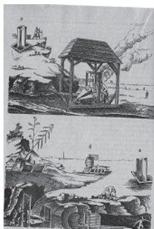
Рис. 3. Иллюстрации к книге М. В. Ломоносова «Первые основания металлургии или рудных дел» (рудничные вентиляционные установки)
