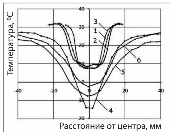
Рис. 3. Распределение температуры кожного покрова после охлаждения смесью пропан/бутан (40/60% мольн., T_0 = -33 °С) и льдом (цилиндр диаметром 20 мм, высотой 30 мм). 1 – лед, t = 30 с; 2 – лед, t = 60 с; 3 – лед, t = 90 с; 4 – спрей T_0 = -33 °С, L = 50 мм, d = 0,1 мм, t = 5 с; 5 – спрей T_0 = -33 °С, L = 100 мм, d = 0,1 мм, t = 36 с; 6 – спрей T_0 = -33 °С, L = 150 мм, d = 0,1 мм, t = 69 с. L – расстояние от сопла, d – диаметр сопла, t – время воздействия
